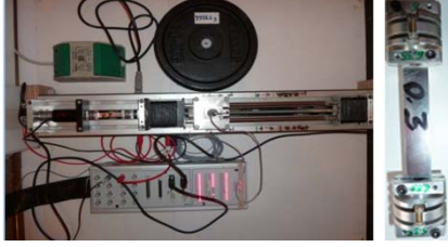
Figure 1 : Le robot expérimental et l'accouplement flexible
